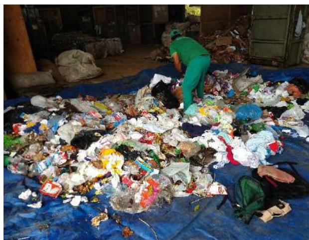
Figura 9 - Homogeneização dos resíduos.
